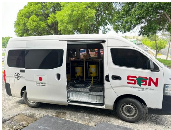
Figura 3 - Vehículo del SGN con el A-10 instalado.
