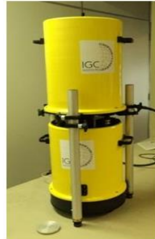
Figura 2 – Gravímetro absoluto A-10/32
