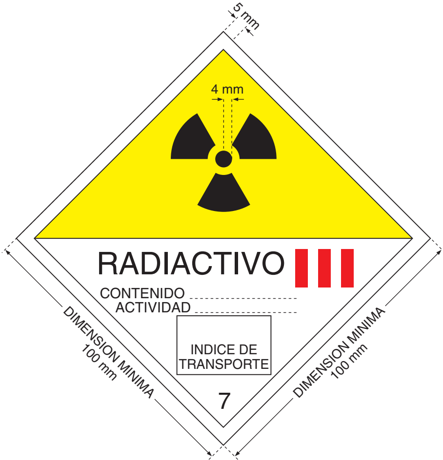
Fig. 4. Etiqueta para la categoría III-AMARILLA. El color de fondo de la mitad superior de la etiqueta será amarillo y el de la mitad inferior blanco, el trébol y los caracteres y líneas impresos serán negros y las barras que indican la categoría serán rojas.
